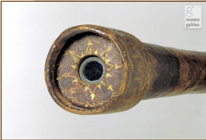
Telescópio de Galileu, c. 1610, 927mm, com poder de ampliação de 20X. Acervo do Museo Galileo, Istituto e Museo di Storia della Scienza, Florença. No detalhe: ocular do telescópio (a lente ocular é de época posterior, pois a lente original se perdeu).
